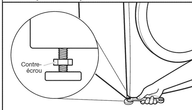
Si la laveuse n'est pas d'aplomb, utiliser une clé plate ou une clé à molette de 9/16" ou 14 mm pour tourner les contre-écrous dans le sens horaire jusqu'à ce qu'ils se trouvent à environ 1/2" (13 mm) de la caisse de la laveuse. Tourner ensuite le pied de nivellement dans le sens horaire pour abaisser la laveuse ou antihoraire pour la soulever. Contrôler à nouveau l'aplomb de la laveuse et vérifier que les quatre pieds sont bien au contact du plancher. Répéter au besoin.
