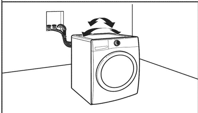
Saisir la laveuse par le dessus et la faire basculer d'avant en arrière tout en s'assurant que les quatre pieds sont en contact ferme avec le plancher. Faire de nouveau basculer la laveuse, transversalement. Si la laveuse bascule, passer à l'étape 18 et ajuster les pieds de nivellement. Si les quatre pieds sont en contact ferme avec le plancher, passer à l'étape 19.
