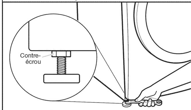
Une fois que la laveuse est d'aplomb et que les quatre pieds sont bien au contact du plancher, de la laveuse établi, utiliser une clé plate ou une clé à molette de 9/16" ou 14 mm pour tourner les contre-écrous sur les pieds de nivellement dans le sens anti-horaire et les serrer fermement contre la caisse de la laveuse.
