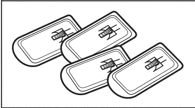
Obturer les trous des boulons à l'arrière de la caisse à l'aide des bouchons d'obturation des trous de boulons de transport fournis avec les pièces de la laveuse.
