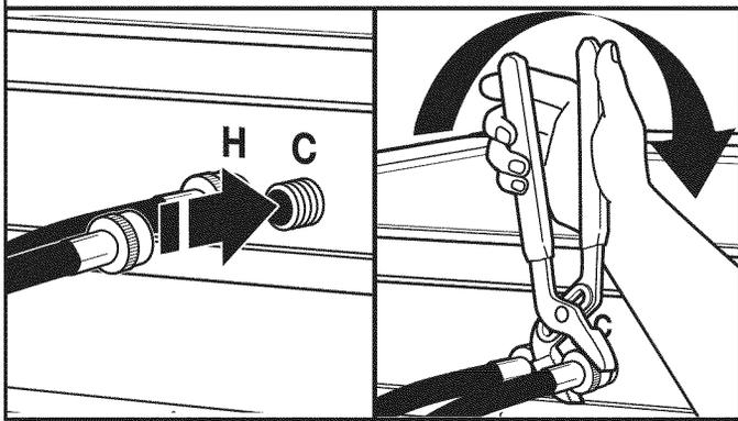
Fixer le tuyau d'eau chaude au robinet d'arrivée d'eau chaude. Visser le raccord à la main jusqu'à ce qu'il soit bien serré. Serrer les raccords de deux tiers de tour supplémentaires à l'aide d'une pince. Répéter pour le robinet d'eau froide.
