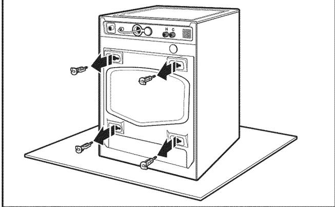
Desserrer les boulons avec une clé de 1/2" (13 mm). Déplacer chaque boulon vers le centre du trou. Retirer les boulons et les cales en plastique de l'arrière de la laveuse. Jeter les boulons et cales d'espacement.
