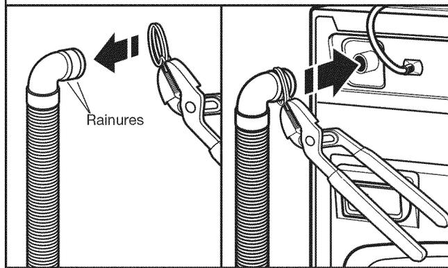
Si la bride n'est pas déjà installée sur l'extrémité coudée du tuyau de vidange, serrer la bride avec une pince et la faire glisser sur l'extrémité du tuyau en la centrant entre les rainures tel qu'illustré. Serrer la bride avec une pince et faire glisser à nouveau l'extrémité coudée du tuyau de vidange sur l'orifice de vidange, puis fixer avec la bride.
