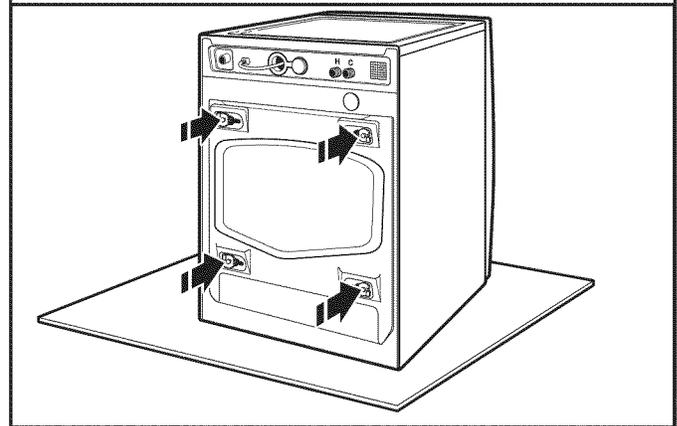
Localiser quatre boulons de transport situés l'arrière de la laveuse.
