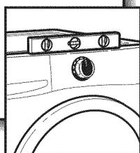
Enlever le morceau de carton placé sous la laveuse. Placer un niveau sur les bords supérieurs de la laveuse en contrôlant chaque côté et l'avant. Si elle n'est pas d'aplomb, faire basculer la laveuse et régler les pieds vers le haut ou vers le bas tel qu'indiqué dans les étapes 18 et 19, et recommencer si nécessaire.
