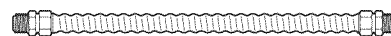
Línea de Gas Flexible Aprobada por CSA Diam. Int. Min. 3/8", Conexión NPT de 1/2", Longitud Máxima de 3 pies (Sólo en Massachusetts)
