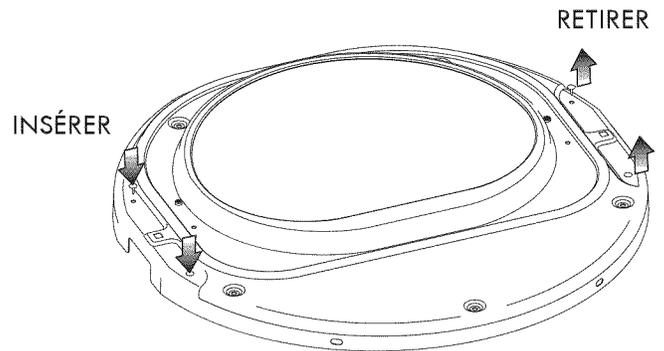
6. Installez la charnière sur le côté opposé de la partie interne de la porte. Fixez la charnière à l'aide des 2 vis à tête cylindrique retirées précédemment. Réinstallez le bouchon en plastique dans le trou carré se trouvant à côté de la charnière.
