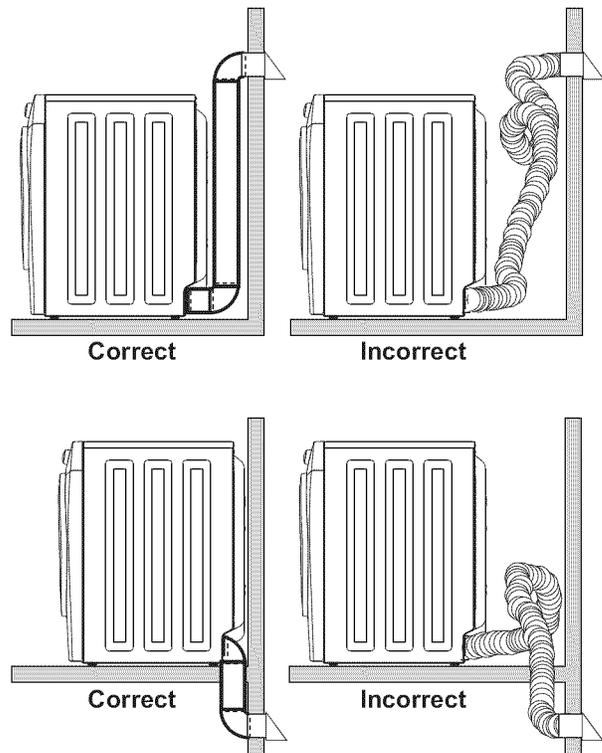
Si votre système actuel utilise une conduite en plastique ou en feuille métallique, remplacez-la par une conduite métallique rigide ou semi-rigide. De plus, assurez-vous que la conduite en place est libre de charpie avant d'installer la conduite de sècheuse.
