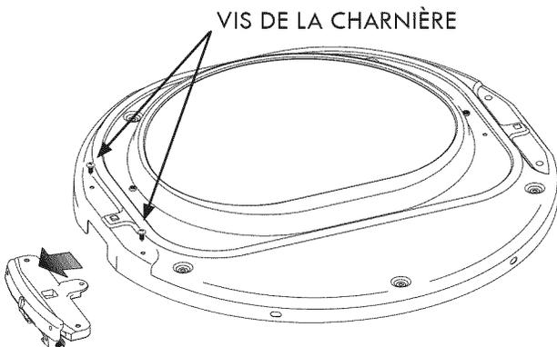
4. À partir de l'arrière de la partie interne de la porte, pincez les languettes de retenue du bouchon carré en plastique pour le dégager. Conservez le bouchon en vue d'une réinstallation.
