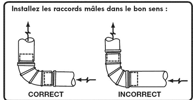
Bien que l'orientation verticale du système d'évacuation soit acceptable, certaines circonstances pourraient influencer sur le rendement de l'appareil.
