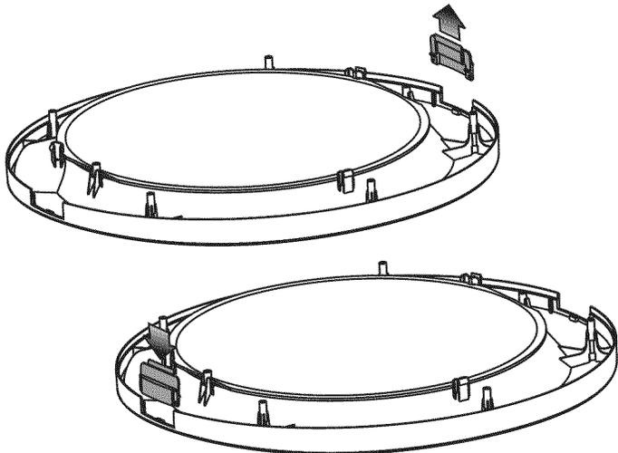
2. Déposez l'ouverture de la partie interne de la porte dans un angle de 90 degrés sur les supports de la découpe de la charnière. Ensuite, faites pivoter la partie interne de la porte dans la partie externe.
