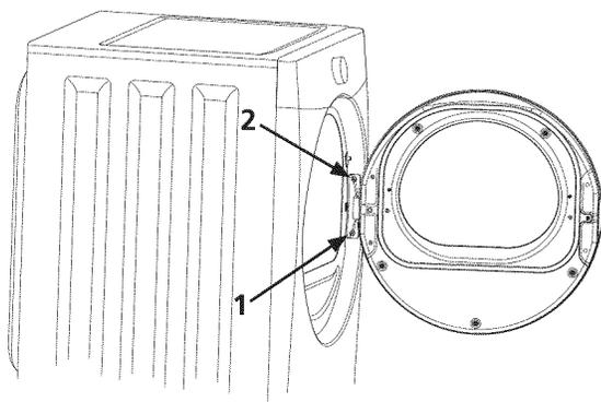
3. En soutenant la porte à deux mains, soulevez complètement cette dernière ainsi que la charnière d'environ 10 mm (3/8 po), de sorte que la tige en « T » se trouvant à l'arrière de la charnière puisse être glissée à l'extérieur de la fente en « T » située sur le panneau avant.
