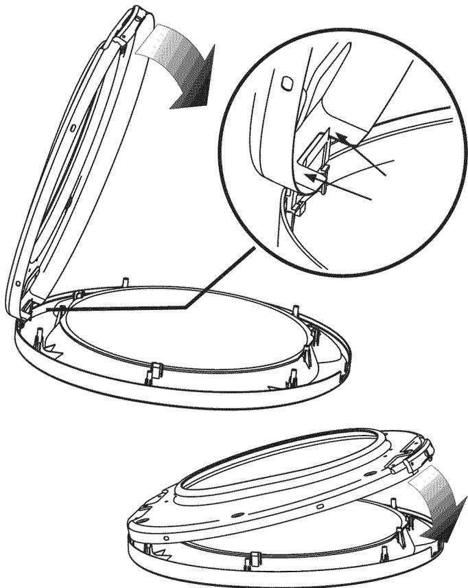
3. Réinstallez les vis à tête dentelée (nos 1 à 5) retirées précédemment. Prenez garde de ne pas endommager le filet des trous en plastique.
