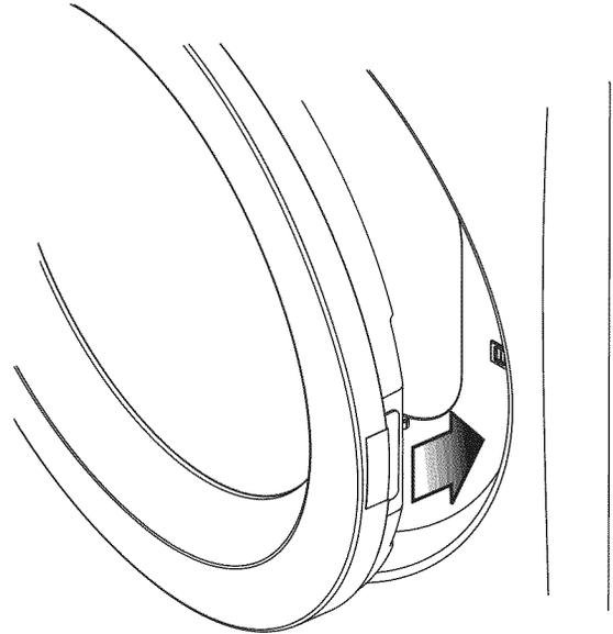
2. Tout en tenant la porte, installez d'abord la vis à tête cylindrique supérieure, puis la vis inférieure.
