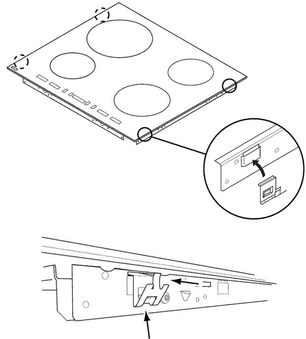
*Insérer le bas de l'attache de montage dans la poche inférieure et enfoncer le dessus de l'attache sur le sommet de la poche pour l'emboîter.*
