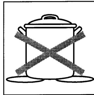
simultanément sur deux brûleurs. Une accumulation excessive de chaleur endommagerait la table de cuisson.
