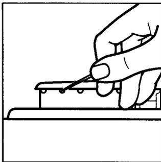
5. Après le nettoyage du tube d'arrivée de gaz et des orifices, réinstaller le chapeau de brûleur. Lors de la réinstallation du chapeau de brûleur, veiller à ce que les ergots d'alignement soient convenablement alignés avec la base du brûleur.
