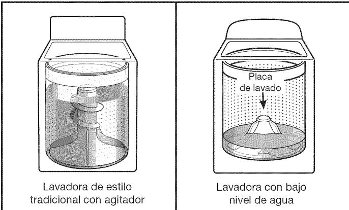
La diferencia más llamativa en su nueva lavadora es el sistema de lavado con placa de lavado y bajo nivel de agua. La lavadora regula automáticamente el nivel del agua de acuerdo al tamaño de la carga; no se necesita un selector de nivel de agua.
