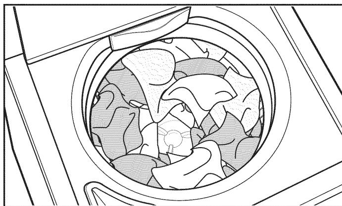
Cargue las prendas de modo uniforme en montones flojos alrededor de la placa de lavado. No cargue las prendas directamente sobre el centro de la placa de lavado; cuando cargue, la placa de lavado deberá estar visible.
