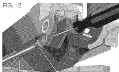
MITER LOCK ROD LOCK NUT
