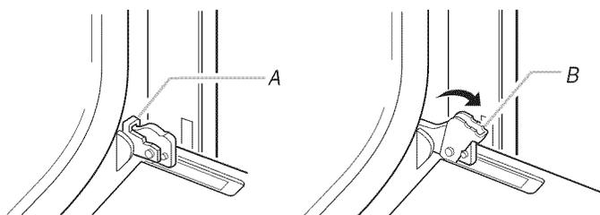
3. Saisir les bords de la porte du four avec les deux mains et fermer la porte du four jusqu'à la position où la fermeture de la porte n'est plus possible. Soulever et tirer la porte du four vers soi et enlever la porte. Conserver la porte du four à part sur une surface de travail couverte.
