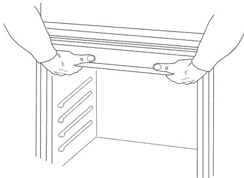
2. Pousser contre la zone du joint du châssis avant pour introduire complètement le four dans le placard et centrer le four dans l'ouverture.
