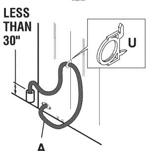
NOTA: Si se requiere una manguera de drenaje más larga, mande a pedir el equipo de extensión de la manguera de drenaje, número de pieza GE WH49X301. Conecte la manguera de drenaje adicional (incluida en el equipo de extensión) a la manguera original usando la abrazadera para la manguera (también incluida en el equipo de extensión).
