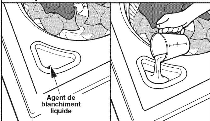
Ne pas remplir excessivement le distributeur ni utiliser plus de une tasse (250 mL) d'agent de blanchiment liquide au chlore. Ne pas utiliser d'agent de blanchiment sans danger pour les couleurs ni de produit Oxi avec un programme utilisant de l'agent de blanchiment au chlore liquide.
