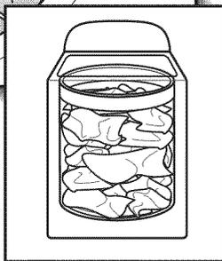
Charger les vêtements sans les tasser et de façon uniforme le long du plateau de lavage. Ne pas placer les vêtements directement au centre du plateau de lavage – celui-ci doit être visible. Essayer de mélanger différents types d'articles pour réduire l'emmêlement.
