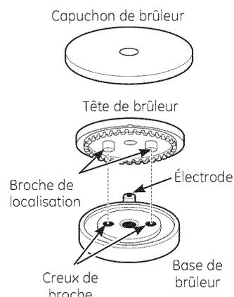
Assurez-vous que la fente de la tête de brûleur soit bien placée sur l'électrode. Le capuchon de brûleur a trois ou quatre broches. Quand vous remettez en place le capuchon, assurez-vous qu'aucune broche ne repose sur la chambre de stabilité.
