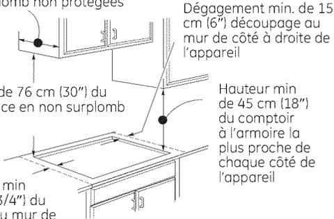
REMARQUE : tous les modèles de surface à cuisson au gaz requièrent un dégagement de 1,1 cm (7/16 po) sous la hauteur de la surface pour la matière combustible.
