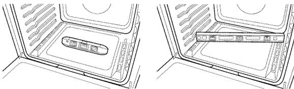
2. Si la cuisinière n'est pas d'aplomb, la tirer de nouveau pour que le pied de nivellement arrière se dégage de la bride antibasculement.
