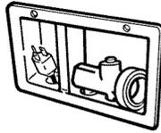
3. Tirer vers le bas sur le collet de blocage tout en poussant le raccord sur l'adaptateur pour robinet.
