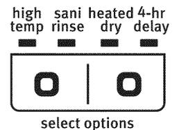
**Hi-Temp (haute température) – (à utiliser uniquement pour les programmes Heavy (lavage intense) et Normal) Ce programme chauffe l'eau lors des étapes de lavage du programme afin d'améliorer le nettoyage.**
