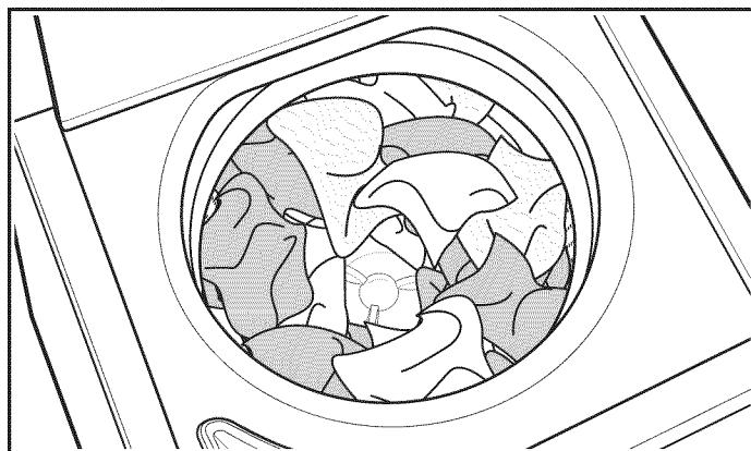
Cargue las prendas de modo uniforme en montones flojos alrededor de la placa de lavado. No cargue las prendas directamente sobre el centro de la placa de lavado; cuando se carga la lavadora, el centro de la placa de lavado debe ser visible.
