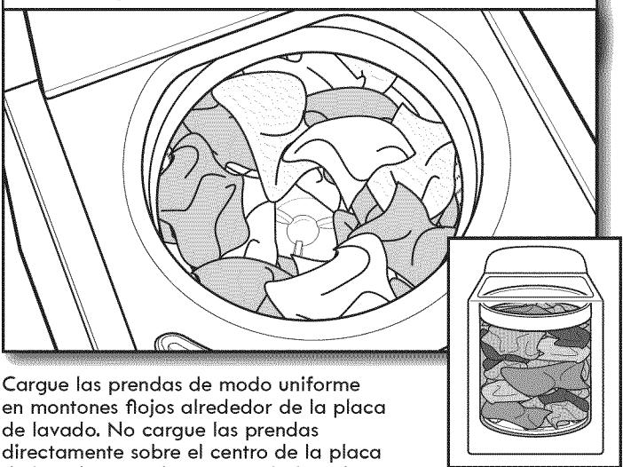
Cargue las prendas de modo uniforme en montones flojos alrededor de la placa de lavado. No cargue las prendas directamente sobre el centro de la placa de lavado; cuando se carga la lavadora, el centro de la placa de lavado debe ser visible. Pruebe mezclar artículos de distintos tamaños para que éstos se enreden menos.
