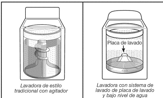
La mayor diferencia en su nueva lavadora es el sistema de lavado con placa de lavado y bajo nivel de agua. La lavadora regula automáticamente el nivel del agua de acuerdo al tamaño de la carga; no se necesita un selector de nivel de agua.
