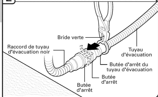
À l'aide d'une pince, ouvrir la petite bride verte de tuyau d'évacuation en la serrant et la glisser sur le connecteur, entre les butées.
