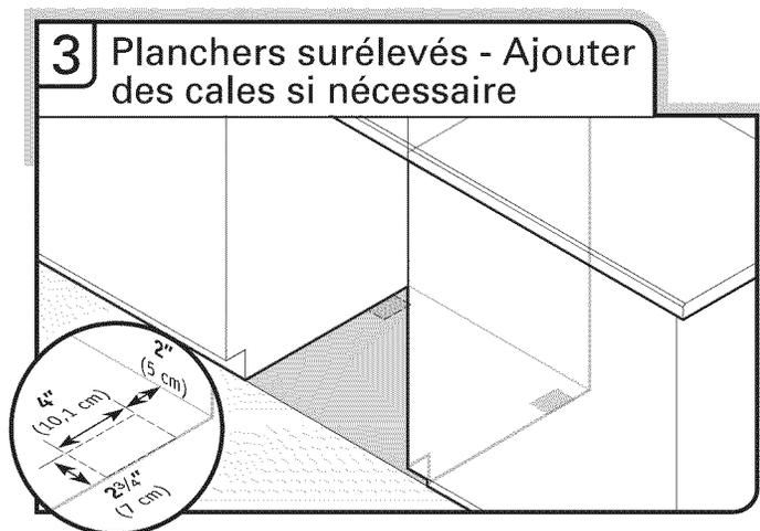
Planchers surélevés (la hauteur du plancher de la cuisine est supérieure à celle de l'ouverture d'encastrement du placard). Par exemple : Le carrelage du plancher de la cuisine n'arrive pas jusque dans l'ouverture du placard. Ajouter des cales selon le besoin dans la zone indiquée pour placer le lave-vaisselle à une hauteur maximale de 34" (86,4 cm) sous le plan de travail.
