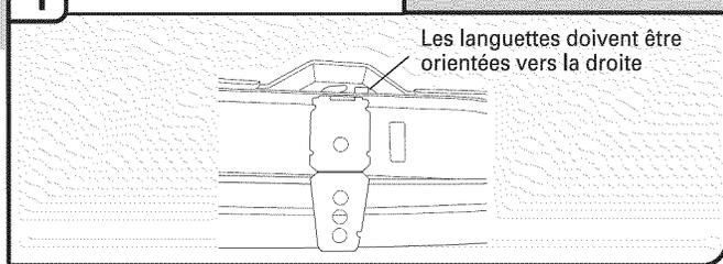
Retirer les brides de l'emballage et les insérer dans les fentes ouvertes sur les côtés supérieurs droit et gauche du collet du lave-vaisselle, tel qu'indiqué.
