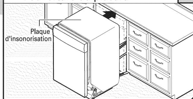
**IMPORTANT :** Si l'on enlève les roulettes, protéger le plancher pour éviter de l'endommager lors des déplacements du lave-vaisselle. Insérer lentement et complètement le lave-vaisselle dans l'ouverture d'encastrement du placard. Veiller à ne pas coincer ou déformer la canalisation de cuivre, le tuyau d'évacuation, le cordon d'alimentation ou le câble de raccordement direct entre le lave-vaisselle et le placard. Enlever le carton placé sous le lave-vaisselle.
