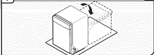
**Conseil utile :** Pour éviter d'endommager le revêtement de sol, placer une feuille de carton sous le lave-vaisselle jusqu'à son installation dans la cavité d'encastrement. Ne pas utiliser le panneau de porte comme surface de travail sans d'abord l'avoir recouvert d'une serviette pour éviter de l'endommager. Faire intervenir deux personnes ou plus – saisir les côtés du cadre de la porte du lave-vaisselle pour placer le lave-vaisselle en appui sur la face arrière.
