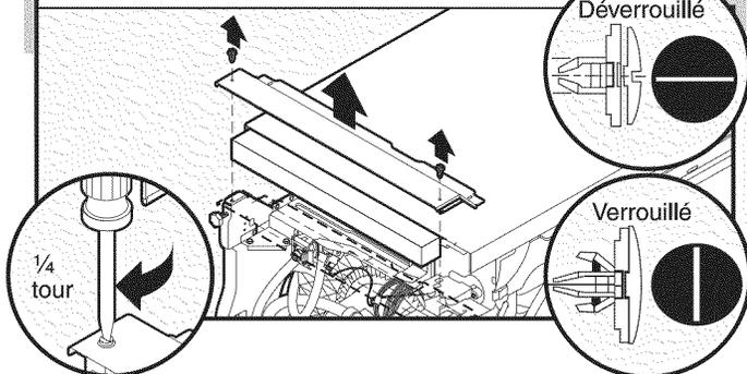
À l'aide d'un tournevis à lame plate, tourner les dispositifs de fixation en plastique d'un quart de tour pour les déverrouiller. Retirer le panneau. Ne pas retirer la fiche technique du panneau d'accès.
