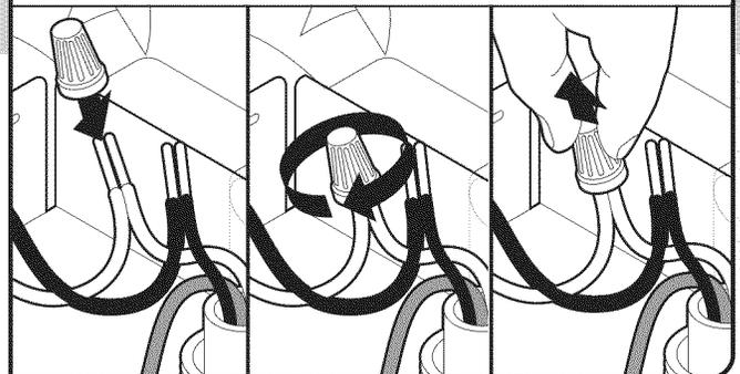
**REMARQUE :** Ne pas pré-torsader les brins des conducteurs. Installer le connecteur de fils en le faisant pivoter. Tirer doucement sur les conducteurs pour vérifier qu'ils sont bien fixés.
