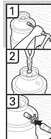
1. À l'aide d'un marteau et d'un tournevis, enfoncez le bouchon d'obturation dans le broyeur à déchets.
