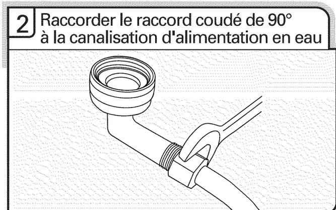
Raccorder le raccord de compression de  $\frac{3}{8}$ " à la canalisation d'alimentation en eau avant d'installer l'appareil dans l'ouverture découpée dans le placard. Le fixer de façon à ce que le raccord de  $\frac{3}{4}$ " soit orienté vers le haut, tel qu'illustré ci-dessus.
