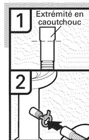
1. Raccordez l'extrémité en caoutchouc du tuyau d'évacuation à la canalisation d'égout en T et coupez si nécessaire. **REMARQUE :** Ne pas couper la section ondulée.
