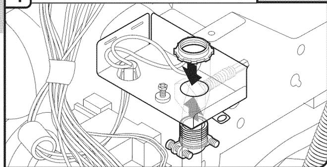
Installer un serre-câble (homologation UL ou CSA). Veiller à ce que les têtes de vis soient orientées vers la gauche après le serrage de l'écrou du serre-câble. Le serre-câble est fourni avec le cordon d'alimentation.
