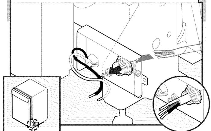
Acheminer le cordon d'alimentation de façon à ce qu'il ne touche ni le moteur du lave-vaisselle, ni la partie inférieure de la cuve du lave-vaisselle. Tirer le câble pour le faire passer à travers le serre-câble (homologation UL/CSA) dans le boîtier de connexion. Le serre-câble n'est pas fourni avec le lave-vaisselle. Le propriétaire doit acheter un serre-câble à vis de 3/8".
