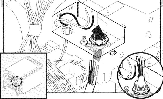
Acheminer le cordon d'alimentation de façon à ce qu'il ne touche pas la zone située entre le moteur du lave-vaisselle et la partie inférieure de la cuve du lave-vaisselle. Tirer le cordon pour l'acheminer à travers le serre-câble dans le boîtier de connexion. Sélectionner des connecteurs de fils (homologation UL ou CSA) conçus pour le raccordement du cordon d'alimentation du domicile au câblage de calibre 16 du lave-vaisselle.
