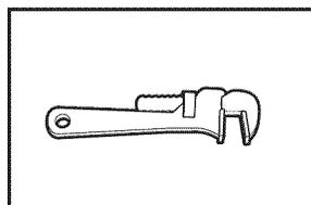
Clé à tuyau de 8" (203 mm) ou 10" (254 mm)
