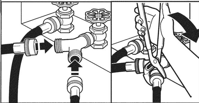
L'une des extrémités du tuyau long comporte un treillis métallique à l'intérieur du raccord. Fixer cette extrémité au raccord en "Y". Fixer le tuyau d'alimentation en eau froide de la laveuse à l'autre extrémité du raccord en "Y". Visser le raccord à la main pour qu'il repose sur le raccord. Terminer le serrage des raccords de deux tiers de tour supplémentaire avec une pince.
