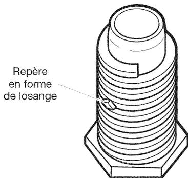
Examiner les pieds de nivellement pour trouver le repère en forme de losange. Visser manuellement les pieds dans les trous pour pieds de nivellement et utiliser une clé pour terminer le vissage, jusqu'à ce que le repère en forme de losange ne soit plus visible.
