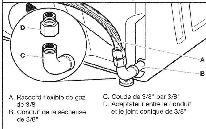
On doit utiliser une combinaison de raccords de tuyauterie pour raccorder la sécheuse à l'alimentation en gaz existante. L'illustration présente un raccordement recommandé. Le raccordement peut varier selon le type, la taille et l'emplacement de la canalisation d'alimentation.
