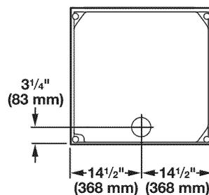
**REMARQUE :** La plupart des installations requièrent un espace minimum de 5" (127 mm) derrière la sècheuse pour le conduit d'évacuation avec coude. Voir "Exigences concernant l'évacuation".
