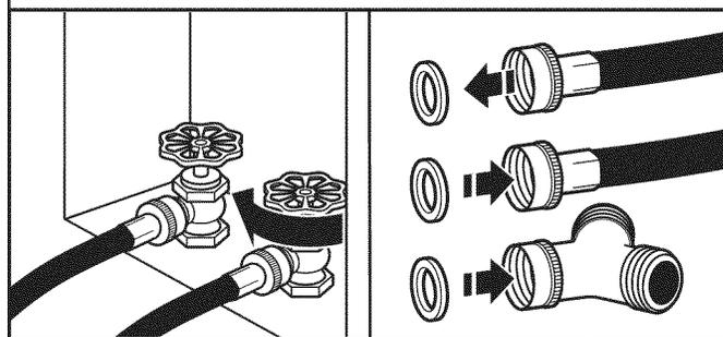
Fermer le robinet d'eau froide et ôter le tuyau d'alimentation de la laveuse.
