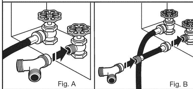
Si l'on a assez d'espace, fixer l'extrémité femelle en laiton du raccord en "Y" au robinet d'eau froide. Voir figure A.
