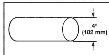
Conduit d'évacuation métallique robuste de 4 pouces (102 mm)
