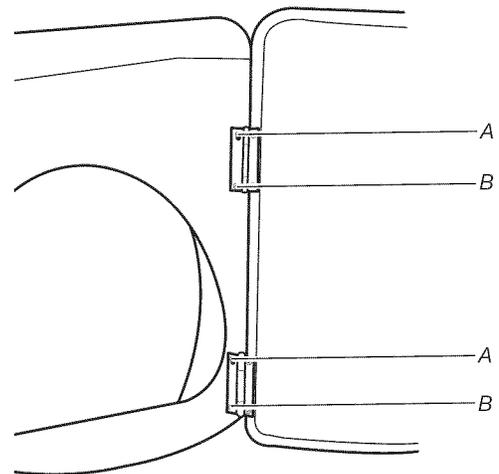
4. Retirer la porte de la sècheuse et les charnières en les soulevant à la verticale. Poser la porte sur une surface plane protégée, côté intérieur (partie interne de la porte) vers le haut. Retirer les deux vis desserrées qui restent du panneau avant de la sècheuse.
