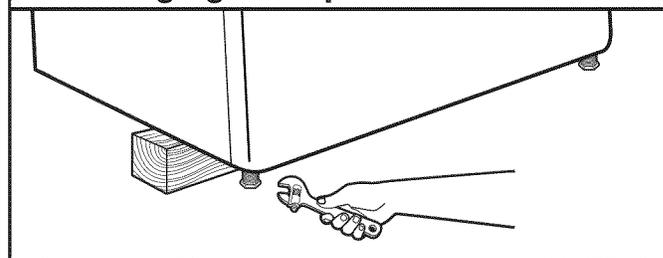
Si la sécheuse n'est pas d'aplomb, la soulever à l'aide d'une cale en bois à l'aide d'une clé pour ajuster les pieds vers le haut ou vers le bas et contrôler de nouveau l'aplomb. Une fois que les pieds de nivellement sont d'aplomb, s'assurer que les quatre pieds sont en contact ferme avec le plancher.
