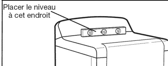
Vérifier l'aplomb de la sécheuse dans le sens transversal. Répéter l'opération dans le sens avant-arrière.
