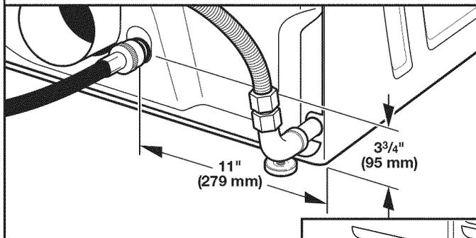
Fixer l'autre extrémité du long tuyau à l'électrovanne située au bas du panneau arrière de la sécheuse. Visser le raccord à la main jusqu'à ce qu'il repose sur le raccord de l'électrovanne. Terminer le serrage des raccords de deux tiers de tour supplémentaire avec une pince.
