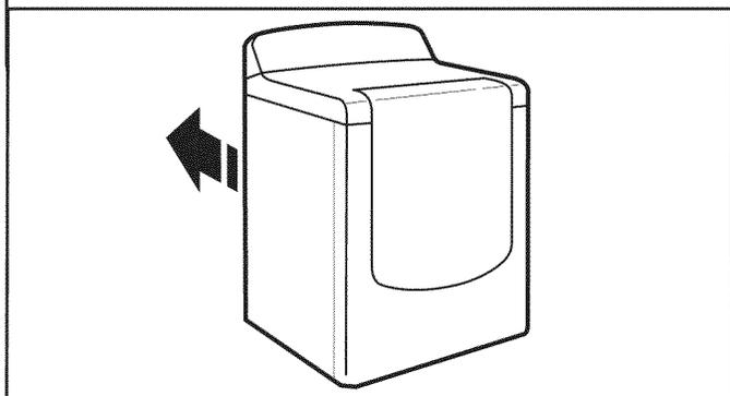
Placer la sécheuse à son emplacement final. Éviter d'écraser ou de déformer le conduit d'évacuation. Une fois la sécheuse en place, retirer le carton sous la sécheuse.
