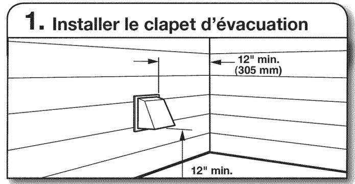
Lors de l'installation du clapet d'évacuation, calfeutrer le côté extérieur de l'ouverture murale autour du clapet d'évacuation.
