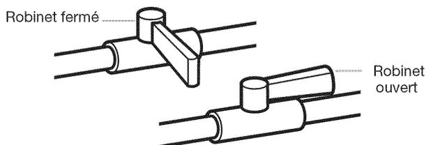
Ouvrir le robinet d'arrêt de la canalisation d'alimentation; le robinet est ouvert lorsque la manette est parallèle à la canalisation de gaz. Vérifier ensuite tous les raccords en les badigeonnant d'une solution de détection de fuites non corrosive approuvée. L'apparition de bulles indique la présence d'une fuite. Veiller à éliminer toute fuite détectée.
