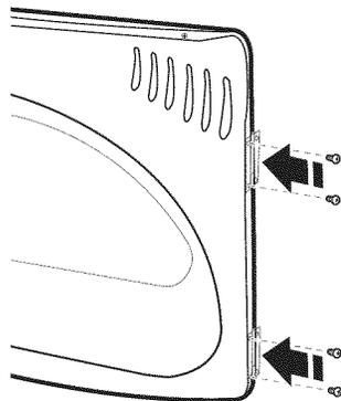
4. Installer les deux charnières sur le panneau avant de la sécheuse à l'aide de 4 vis. Utiliser le côté sans fente pour fixer la charnière sur le panneau avant.
