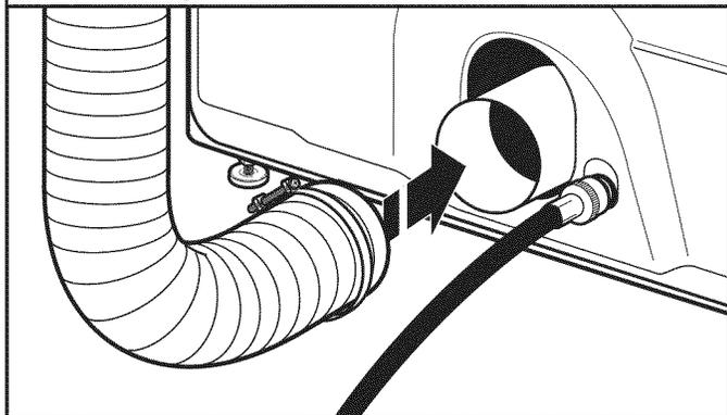
À l'aide d'une bride de fixation de 4" (102 mm), relier le conduit d'évacuation à la bouche d'évacuation de la sécheuse. Si l'on réalise le raccordement au conduit d'évacuation existant, s'assurer que celui-ci est propre. Le conduit d'évacuation doit être fixé par-dessus la bouche d'évacuation de la sécheuse et à l'intérieur du clapet d'évacuation. Vérifier que le conduit d'évacuation est bien fixé au clapet d'évacuation au moyen d'une bride de 4" (102 mm).
