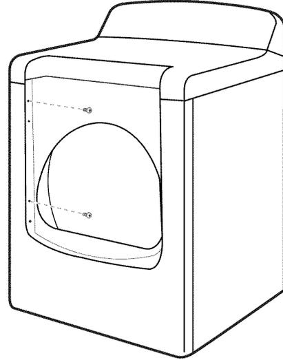
6. Suspender la porte : insérer les têtes de vis dans les trous de fente supérieurs des charnières et glisser la porte vers le bas. Aligner les trous de vis inférieurs de la charnière et de la porte. Fixer deux vis inférieures. Serrer toutes les vis de la charnière.
