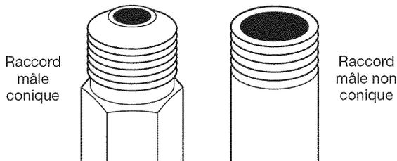
Retirer le capuchon rouge de la canalisation de gaz. À l'aide d'une clé pour serrer, raccorder l'alimentation en gaz à la sécheuse. Utiliser un composé d'étanchéité des tuyauteries sur tous les filetages des raccords mâles non coniques. Si on utilise un conduit métallique souple, veiller à ce qu'il ne soit pas pincé.
