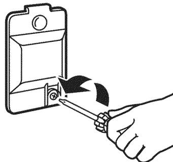
3. Tourner l'ampoule dans le sens antihoraire. Remplacer l'ampoule seulement par une ampoule de 10 watts pour appareil électroménager. Réinstaller le couvercle et le fixer avec la vis.
