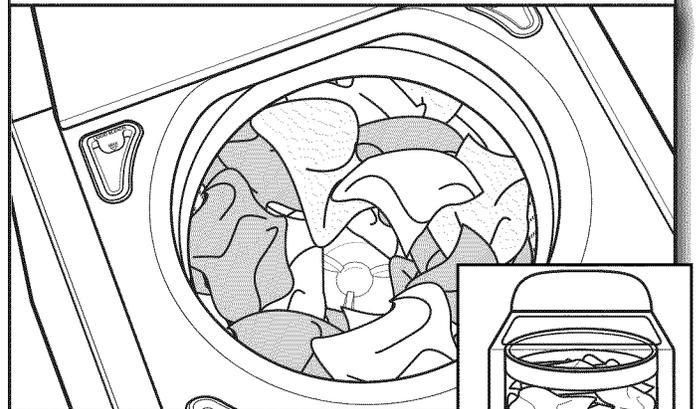
Charger les vêtements sans les tasser et de façon uniforme le long du plateau de lavage. Ne pas placer les vêtements directement au centre du plateau de lavage – celui-ci doit être visible. Essayer de mélanger différents types d'articles pour réduire l'emmêlement.
