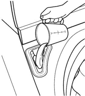
**IMPORTANT :** Ne pas verser de détergent dans le programme CLEAN WASHER with AFFRESH® (NETTOYAGE DE LA LAVEUSE avec AFFRESH®). Pour éviter tout dommage à long terme, ne pas utiliser plus que la quantité d'agent de blanchiment recommandée.
