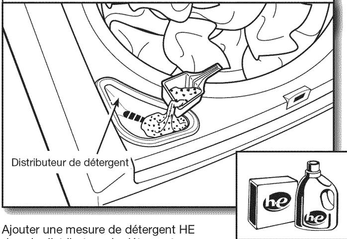
Ajouter une mesure de détergent HE dans le distributeur de détergent.
