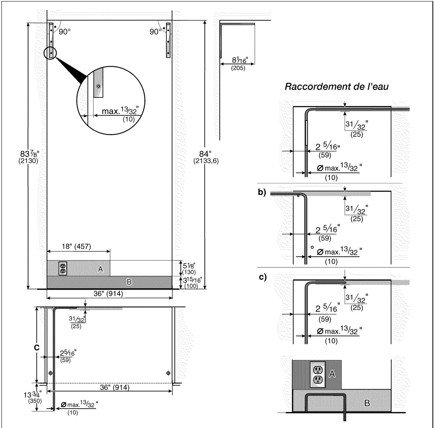
**Remarque :** La cavité doit être carrée. La paroi latérale de la cavité doit se trouver dans l'alignement.
