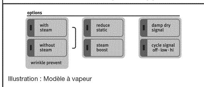
Pour ajouter des options supplémentaires telles que Reduce Static (réduction de l'électricité statique), Wrinkle Prevent™, Wrinkle Prevent™ avec vapeur et/ou Steam Boost (puissance vapeur), appuyer sur le bouton correspondant à l'option souhaitée.
