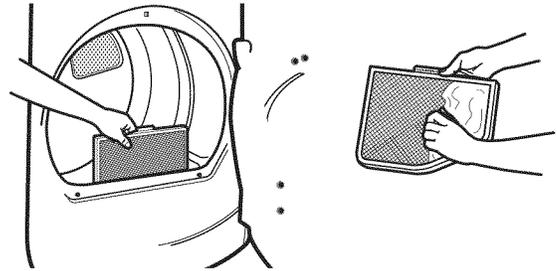
2. Remettre le filtre à charpie fermement en place en l'enfonçant.
