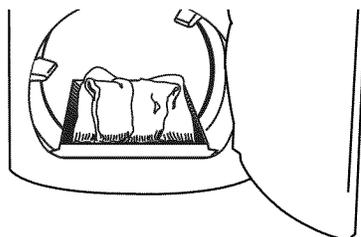
3. Placer les articles mouillés sur la grille de séchage. Laisser suffisamment d'espace entre les articles pour permettre à l'air de circuler. La grille de séchage ne bouge pas mais le tambour pivote; veiller à laisser suffisamment d'espace entre les articles et à l'intérieur du tambour de la sècheuse. Veiller à ce que les articles ne pendent pas par-dessus les bords de la grille de séchage ou entre les barreaux de la grille.
