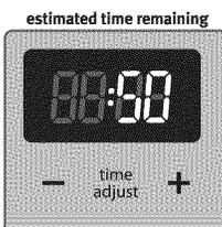
Lorsqu'on sélectionne un programme minuté, la durée par défaut apparaît sur l'affichage. Appuyer sur les boutons + ou - pour augmenter ou diminuer la durée par tranches d'une (1) minute. Appuyer sans relâcher pour modifier la durée par tranches de 5 minutes.
