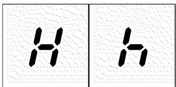
La placa tiene un indicador de superficie caliente para cada elemento. Le muestra qué elementos continúan calientes. El indicador de superficie caliente tiene dos niveles.
