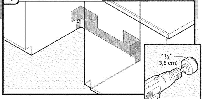
Si nécessaire, percer un trou de  $1\frac{1}{2}$ " (3,8 cm) de diamètre dans la paroi du placard ou l'arrière de l'ouverture la plus proche de l'évier.
