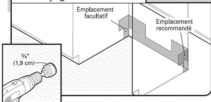
Percer un trou de  $\frac{3}{4}$ " (1,9 cm) dans le côté droit de la paroi latérale ou arrière du placard.
