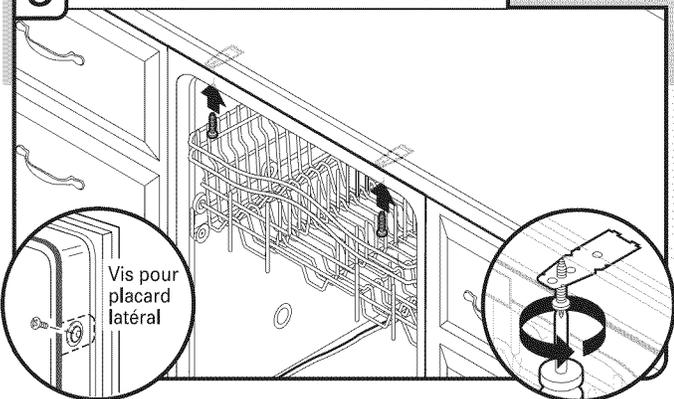
**REMARQUE :** Ne pas faire tomber de vis au fond du lave-vaisselle. Pour un montage latéral, pré-percer des avant-trous (avec un foret de 1/8") dans le placard avant d'installer les vis pour que le bois ne se fende pas.
