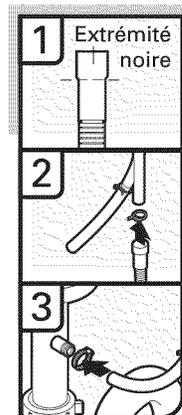
1. Raccorder l'extrémité noire du tuyau d'évacuation au dispositif de brise-siphon et couper si nécessaire.
