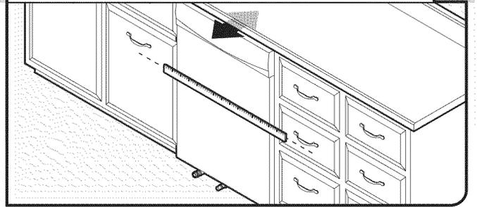
Aligner l'avant du panneau de porte du lave-vaisselle avec les portes des placards. Il faudra peut-être ajuster l'alignement de celui-ci pour qu'il soit en affleurement avec les placards.
