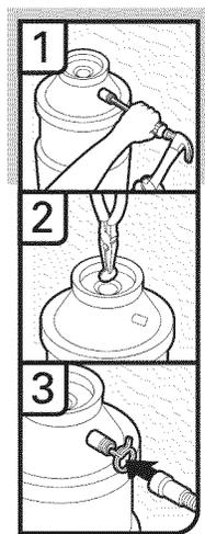
1. À l'aide d'un marteau et d'un tournevis, enfoncer le bouchon d'obturation dans le broyeur à déchets.
