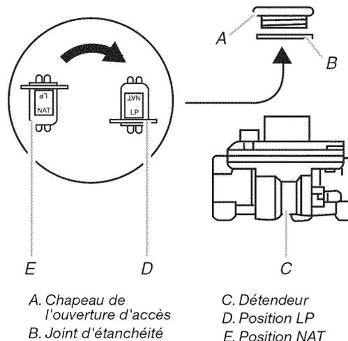
3. Tester le détendeur et la canalisation de gaz.
