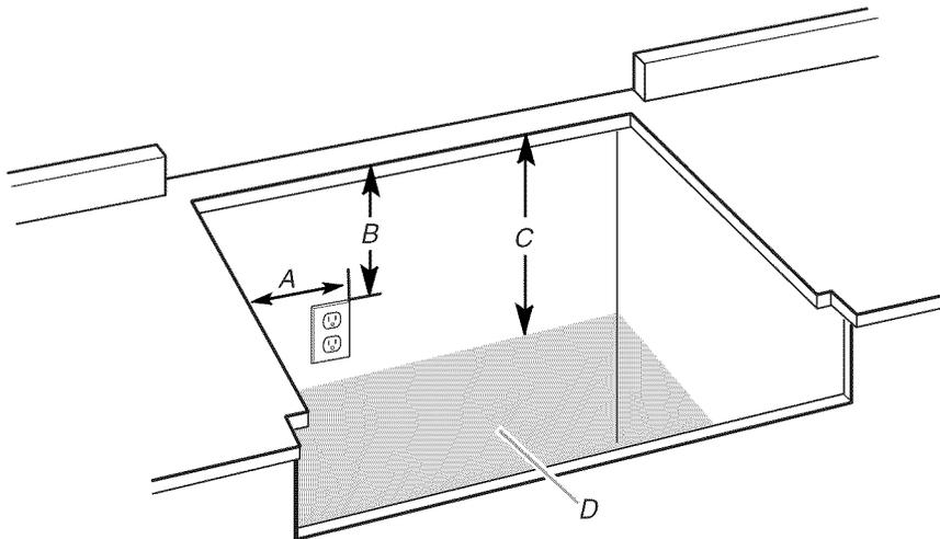
A. La prise de courant à 3 alvéoles reliée à la terre doit se trouver du côté gauche de l'ouverture découpée, à 16" (40,6 cm) max. de la paroi latérale de l'encastrement
