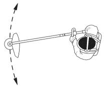
Al cortar y barrer debe utilizar la aceleración máxima para obtener un buen resultado.
