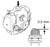
¡NOTA! ¡Utilice siempre el tipo de bujía recomendado! Una bujía incorrecta puede arruinar el pistón y el cilindro. Asegúrese de que la bujía tenga supresión de perturbaciones radioeléctricas.
