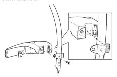
Monter le pare-poussière sur l'arbre. L'écrou doit être complètement entouré par le pare-poussière.
