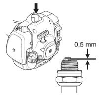
**REMARQUE!** Toujours utiliser le type de bougie recommandé! Une bougie incorrecte peut endommager le piston/le cylindre. S'assurer que la bougie est dotée d'un antiparasites.
