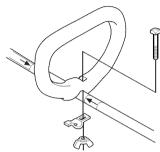
Monter le boulon, la plaque de serrage et l'écrou à oreilles comme indiqué sur la figure. Serrer l'écrou à oreilles.
