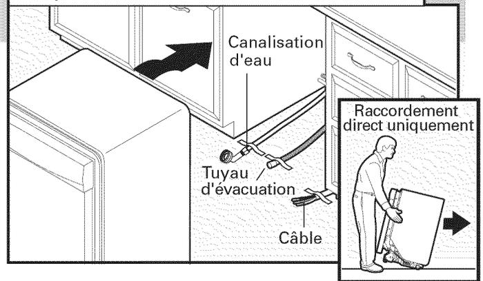
**IMPORTANT :** Vérifier que le câblage est bien installé. Saisir les côtés du lave-vaisselle par les rebords du panneau de porte. Incliner le lave-vaisselle vers l'arrière sur ses roulettes et approcher l'appareil de l'ouverture dans le placard.
