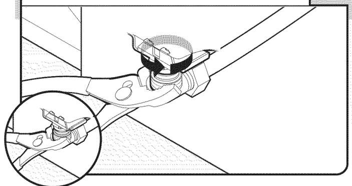
S'assurer que la rondelle de caoutchouc est correctement installée dans le raccord. Enfiler le raccord de  $\frac{3}{4}$ " vers le haut jusqu'à la valve et serrer à la main afin d'éviter de fausser le filetage. Serrer à la main jusqu'à ce que le raccord soit serré. À l'aide d'une pince, vérifier l'étanchéité du raccord.  $\frac{1}{4}$  à  $\frac{1}{2}$  tour supplémentaire peut s'avérer nécessaire pour créer l'étanchéité du joint de caoutchouc.
