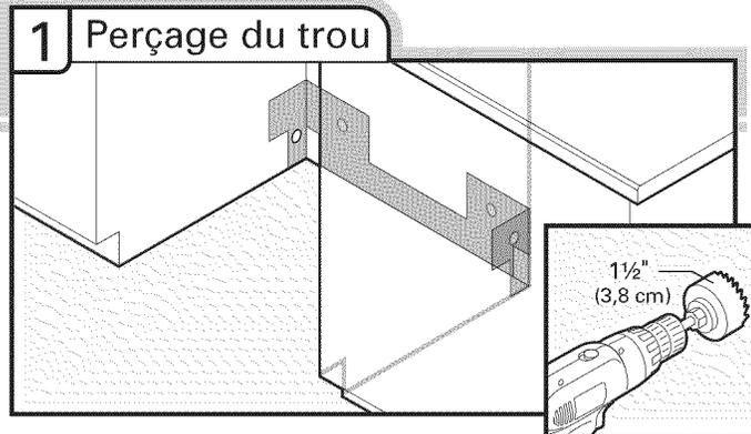
Si nécessaire, percer un trou de 1 1/2" (3,8 cm) de diamètre dans la paroi du placard ou l'arrière de l'ouverture la plus proche de l'évier.
