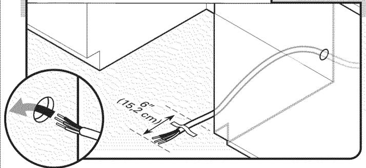
Acheminer le câble de la source d'alimentation électrique à travers le trou dans le placard (le câble doit dépasser par le côté avant droit de l'ouverture d'encastrement du placard).
