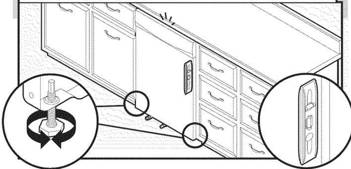
Vérifier que chaque pied de réglage de l'aplomb est fermement en appui sur le sol. Fermer et verrouiller la porte; placer un niveau contre le panneau avant. Vérifier que le lave-vaisselle est centré de l'avant vers l'arrière dans l'ouverture. Si nécessaire, régler le pied de nivellement jusqu'à ce que le lave-vaisselle soit d'aplomb. Répéter ces opérations pour l'autre côté du lave-vaisselle.
