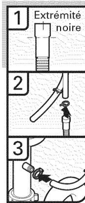
1. Raccorder l'extrémité noire du tuyau d'évacuation au dispositif de brise-siphon et couper si nécessaire. (Ne pas couper la section ondulée).
