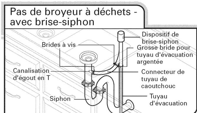
**Pas de broyeur à déchets - avec brise-siphon**
