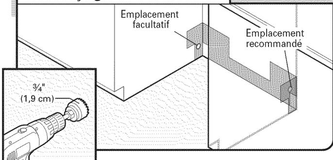
Percer un trou de  $\frac{3}{4}$ " (1,9 cm) dans le côté droit de la paroi latérale ou arrière du placard. Voir les dimensions du produit et de l'ouverture d'encastrement du placard.
