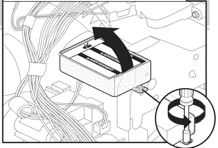
À l'aide d'une clé à douille, un tourne-écrou ou un tournevis Phillips de 1/4", ôter le couvercle du boîtier de connexion. Le conserver pour utilisation ultérieure.
