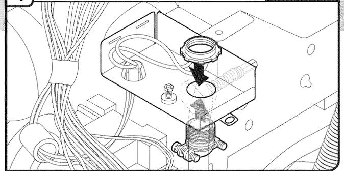
Installer un serre-câble (homologation UL ou CSA). S'assurer que les têtes de vis soit orientées vers la gauche lors du serrage de l'écrou à conduit. Le serre-câble est fourni avec le cordon d'alimentation.
