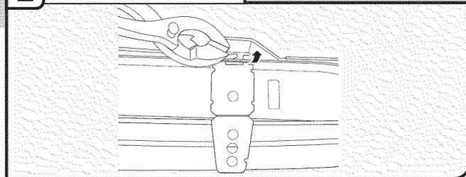
Insérer la bride dans l'encoche du collet. À l'aide d'une pince, replier la languette vers le bas pour fixer la bride. Répéter cette étape pour l'autre côté.
