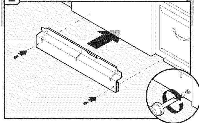
Maintenir les deux panneaux ensemble et les placer contre les pieds du lave-vaisselle. Réinstaller les vis à travers les trous du panneau d'accès et les fentes du panneau inférieur à l'aide d'un tournevis Phillips ou tournevis de 1/4".
