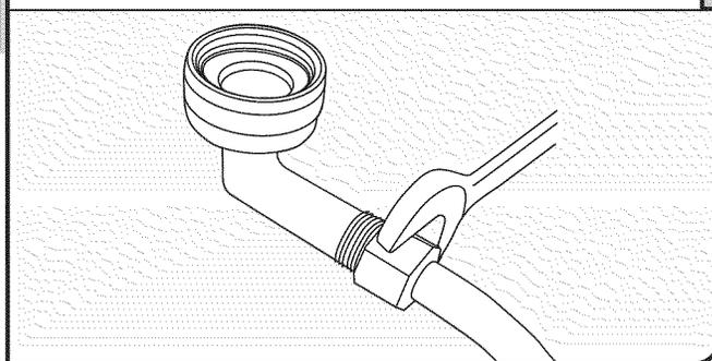
Raccorder le raccord de compression de  $\frac{3}{4}$ " à la canalisation d'alimentation en eau avant d'installer l'appareil dans l'ouverture découpée dans le placard. Le fixer de façon à ce que le raccord de  $\frac{3}{4}$ " soit orienté vers le haut.
