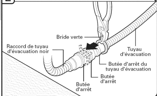
A l'aide d'une pince, ouvrir la petite bride de tuyau d'évacuation verte en la serrant et la glisser sur le connecteur, entre les butées.
