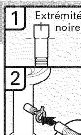
1. Raccorder l'extrémité noire du tuyau d'évacuation à la canalisation d'égout en T et couper si nécessaire. (Ne pas couper la section ondulée).
