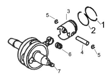
**Description APG Part No.** Part. No SP-GG100-C-01 **COMPRESSION RING A** GE1E45F-C-01 SP-GG100-C-02 **COMPRESSION RING B** GE1E45F-C-02 SP-GG100-C-03 **PISTON** GE1E45F-C-03 SP-GG100-C-04 **PISTON PIN** GE1E45F-C-04 SP-GG100-C-05 PISTON PIN CLIP(10mm) GE1E45F-C-05 SP-GG100-C-06 NEEDLE BEARING(φ14×φ10×13) GE1E45F-C-06 SP-GG100-C-07 **CRANKSHAFT** GE1E45F-C-07
