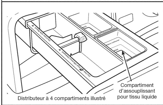
Verser une mesure de l'assouplissant pour tissu liquide dans le compartiment d'assouplissant pour tissu liquide. Toujours suivre les instructions du fabricant pour connaître la quantité d'assouplissant pour tissu adéquate en fonction de la taille de la charge.
