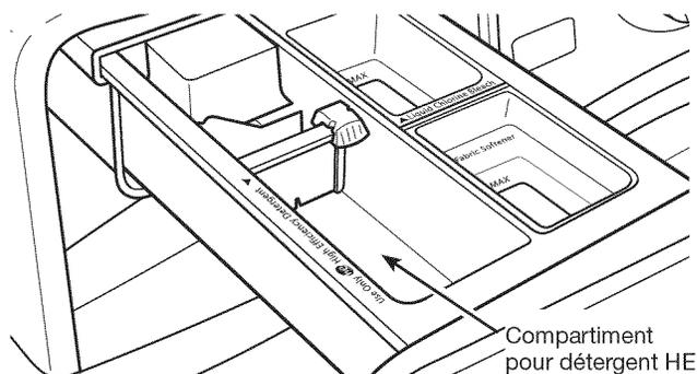
Verser une mesure de détergent HE dans le compartiment à détergent. Pour du détergent en poudre, faire glisser le sélecteur vers la gauche. Pour du détergent liquide, faire glisser le sélecteur vers la droite.
