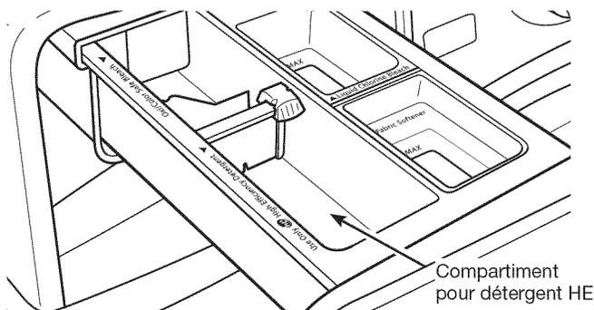
Verser une mesure de détergent HE dans le compartiment à détergent. Pour du détergent en poudre, faire glisser le sélecteur vers la gauche. Pour du détergent liquide, faire glisser le sélecteur vers la droite.
