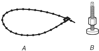
A. Fleje de atadura reforzado B. Patas niveladoras delanteras con tuercas (2)
