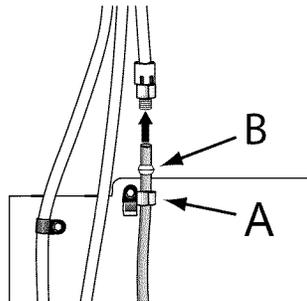
5. Placer l'extrémité du tube en cuivre dans l'orifice d'entrée du robinet d'eau. Adapter légèrement le tube. Ne pas plier le tube, de façon à joindre directement l'orifice d'entrée.
