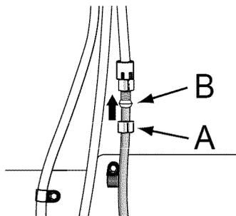
6. Glisser l'écrou en laiton par-dessus l'olive et le visser sur l'orifice d'entrée.
