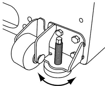
3. Ouvrir la porte à nouveau pour vérifier qu'elle se ferme aussi facilement que souhaité. Si tel n'est pas le cas, incliner le réfrigérateur un peu plus vers l'arrière en tournant les deux vis de réglage dans le sens des aiguilles d'une montre. Plusieurs tours peuvent s'avérer nécessaires, les deux vis de réglage devant être tournées autant l'une que l'autre.
