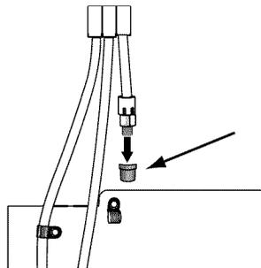
4. Placer l'écrou (A) et l'olive (B) en laiton à l'extrémité du tube en cuivre comme illustré.
