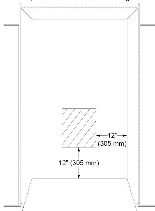
POSITION DU RACCORDEMENT ÉLECTRIQUE -
