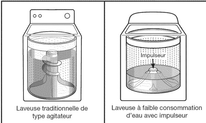
La nouveauté la plus flagrante de cette nouvelle laveuse est son système de lavage à faible consommation d'eau avec impulseur. La laveuse ajuste automatiquement le niveau d'eau en fonction de la taille de la charge - nul besoin de sélecteur de niveau d'eau.
