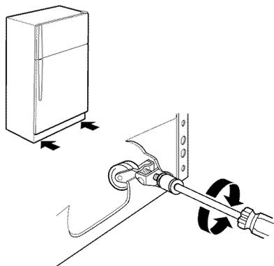
3. Ouvrir les deux portes de nouveau et s'assurer qu'elles se ferment aussi facilement que vous le désirez. Sinon, incliner le réfrigérateur un peu plus vers l'arrière en tournant les deux vis de nivellement vers la droite. Plusieurs tours peuvent être nécessaires.
