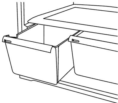
2. Soulever l'avant du bac pour retirer le support du couvercle. Soulever le couvercle et le glisser vers l'extérieur.
