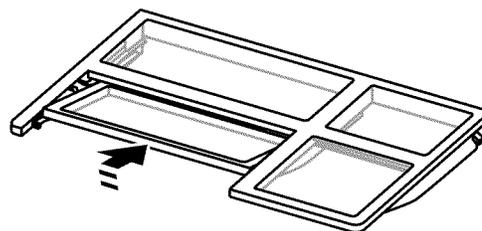
3. Réinstaller la tablette toute entière en la guidant dans le cadre de la porte et en la poussant vers l'intérieur au-delà de la butée. Incliner l'avant de la tablette vers le haut jusqu'à ce qu'elle dépasse la butée et l'insérer.
