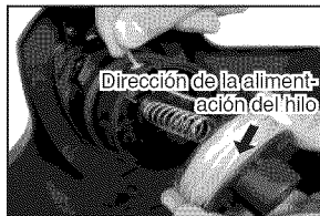
Figura 27 - Inserción del hilo de corte por la caja
