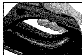
Figure 18 - Enfoncez le bouton de verrouillage, puis appuyez sur la gâchette.
