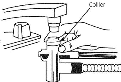
**Nota :** Le petit tuyau du raccord unicouple transporte l'eau du robinet au lave-vaisselle. Le grand tuyau transporte l'eau du lave-vaisselle à l'évier. Orienter le robinet avec le raccord unicouple en place pour que l'eau du raccord unicouple s'écoule dans l'égout de l'évier.
