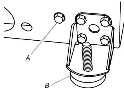
A. Vis de réglage des roulettes avant
