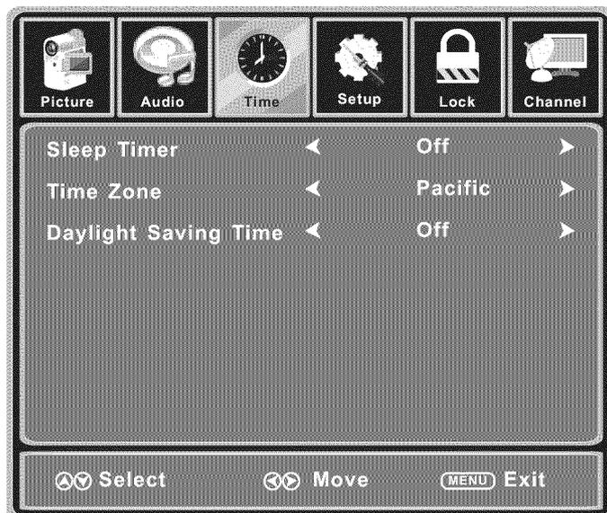
Temporizador: Se puede ajustar el temporizador de apagado automático desde 5 hasta 240 minutos, o desactivar la función.
