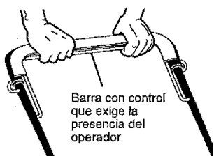
CONTROL DE LA IMPULSIÓN ENGRANCHAR
