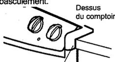
Assurez-vous que le bord du comptoir s'adapte parfaitement à l'extrémité du tableau de commande à l'avant
