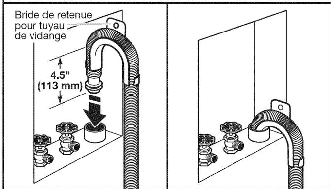
Placer le tuyau dans le tuyau rigide de rejet à l'égout (illustré sur l'image) ou par-dessus le côté de l'évier de buanderie.
