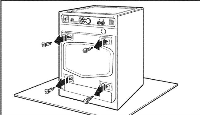
Desserrer les boulons avec une clé de 13 mm (1/2"). Déplacer chaque boulon vers le centre du trou. Retirer les boulons et les cales en plastique de l'arrière de la laveuse. Jeter les boulons et cales d'espacement.
