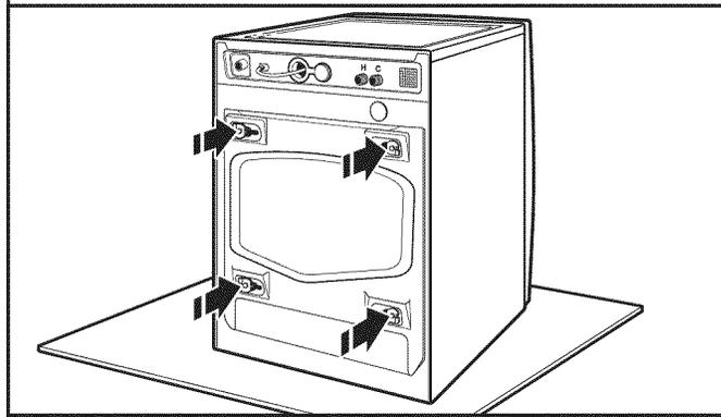
Localiser quatre boulons de transport situés l'arrière de la laveuse.
