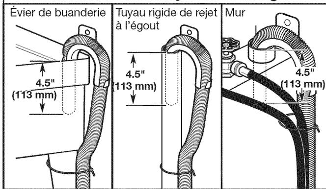
Fixer le tuyau de vidange au pied de l'évier de buanderie, au tuyau de rejet à l'égout ou aux tuyaux d'arrivée d'eau pour le tuyau de rejet à l'égout mural avec l'attache de fixation perlée.
