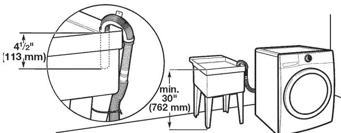
Capacité minimale : 20 gal. (76 L). Le sommet de l'évier de buanderie doit se trouver à au moins 30" (762 mm) du plancher; ne pas l'installer à plus de 96" (2,44 m) du fond de la laveuse.
