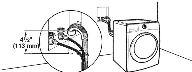
Voir les exigences pour le système de vidange avec tuyau rigide de rejet à l'égout au plancher.
