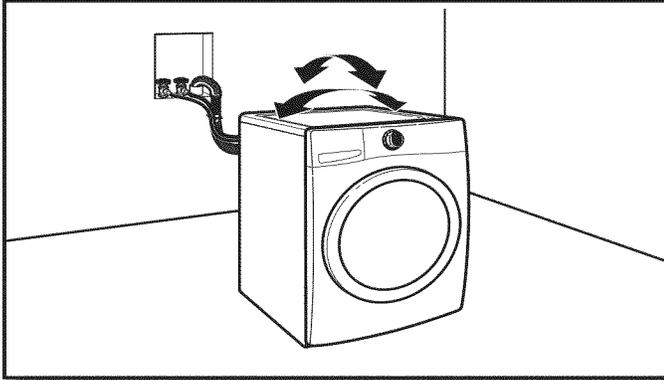
Saisir la laveuse par le dessus et la faire basculer d'avant en arrière tout en s'assurant que les quatre pieds sont en contact ferme avec le plancher. Faire de nouveau basculer la laveuse, transversalement. Si la laveuse bascule, passer à l'étape 17 et ajuster les pieds de nivellement. Si les quatre pieds sont en contact ferme avec le plancher, passer à l'étape 18.
