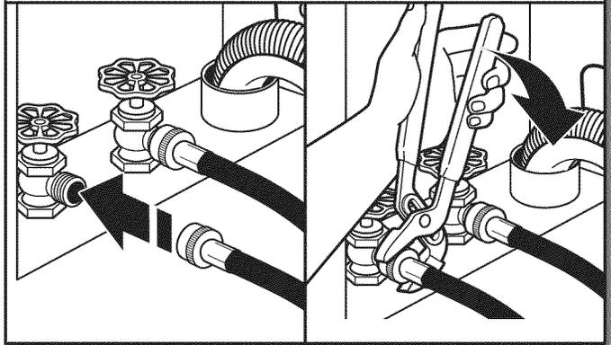
Fixer le tuyau au robinet d'eau chaude. Visser le raccord à la main pour qu'il repose sur la rondelle. Serrer les raccords de deux tiers de tour supplémentaires à l'aide d'une pince. Répéter cette étape avec le deuxième tuyau pour le robinet d'eau froide.
