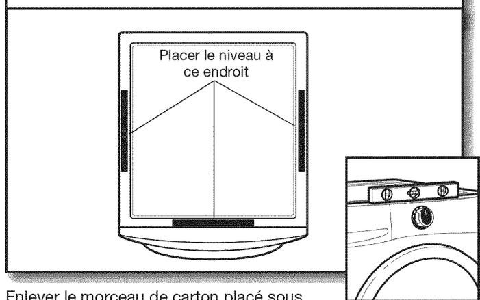
Enlever le morceau de carton placé sous la laveuse. Placer un niveau sur les bords supérieurs de la laveuse en contrôlant chaque côté et l'avant. Si elle n'est pas d'aplomb, faire basculer la laveuse et régler les pieds vers le haut ou vers le bas tel qu'indiqué dans les étapes 17 et 18, et recommencer si nécessaire.
