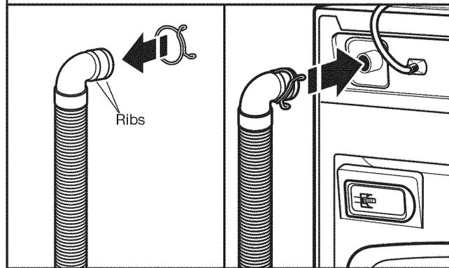
Si la bride n'est pas déjà installée sur l'extrémité coudée du tuyau de vidange, la faire glisser sur l'extrémité du tuyau en la centrant entre les rainures tel qu'illustré. Serrer la bride avec une pince et faire glisser à nouveau l'extrémité coudée du tuyau de vidange sur l'orifice de vidange, puis fixer avec la bride.
