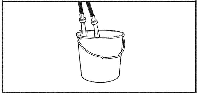
Faire couler l'eau par les tuyaux dans l'évier de buanderie, le tuyau rigide de rejet à l'égout ou le seau pendant quelques secondes pour éviter toute obstruction. On doit laisser couler l'eau jusqu'à ce qu'elle soit limpide.
