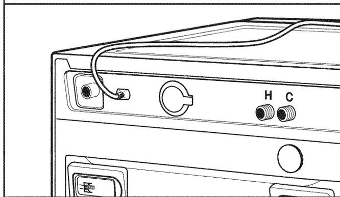
Retirer la sangle jaune d'expédition du cordon. Placer délicatement le cordon d'alimentation par dessus la laveuse pour permettre le libre accès à l'arrière de la laveuse.
