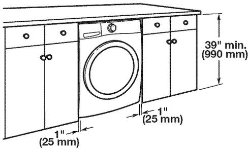
**Installation dans un encastrement ou un placard (laveuse uniquement) :**
