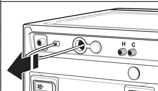
Tirer sur le cordon d'alimentation pour le dégager de l'ouverture du panneau arrière et boucher le trou à l'aide du cache fourni.
