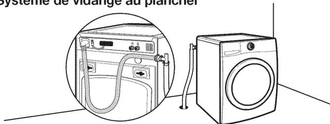
Le système de vidange au plancher nécessite un ensemble de brise-siphon (pièce numéro 285834), deux ensembles de raccordement (pièce numéro 285835) et une rallonge de tuyau de vidange (pièce numéro 285863) qui peuvent être achetés séparément. Voir "Autres pièces". Hauteur minimale du brise-siphon : 28" (710 mm) à partir du fond de la laveuse. (Des tuyaux supplémentaires peuvent être requis).
