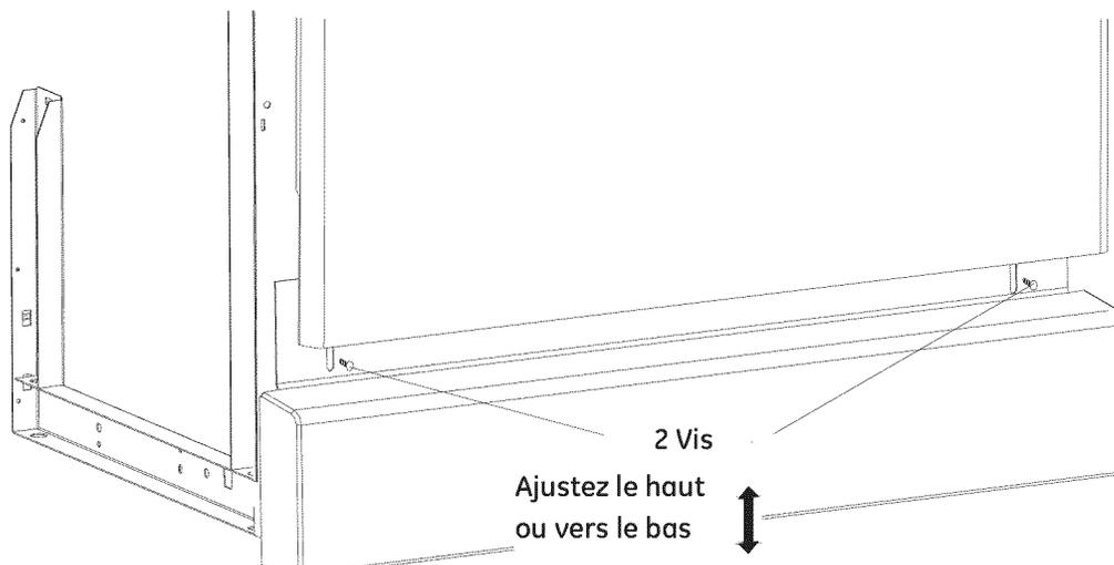
Serrer les deux vis de fixation de plinthe. La plinthe doit demeurer en contact avec le sol pour assurer que le lave-vaisselle fonctionne en silence.
