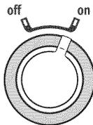
Si l'on souhaite ajouter l'option Deep Clean (nettoyage en profondeur) et (ou) Extra Rinse (rinçage supplémentaire), tourner à ON (marche) le bouton correspondant à cette caractéristique.
