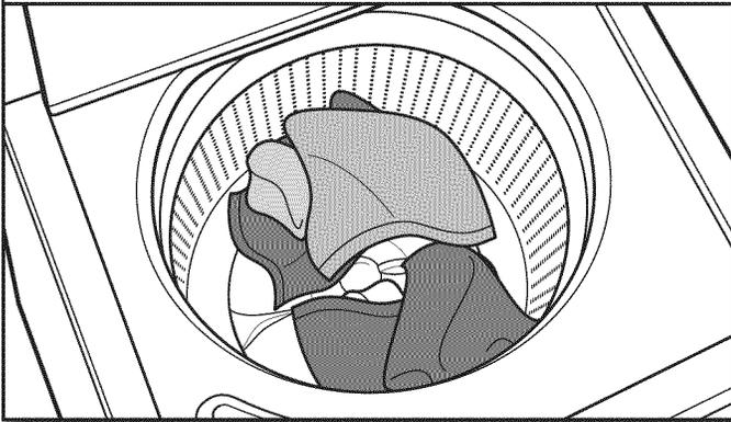
Charger les vêtements sans les tasser et de façon uniforme le long de la paroi du panier. Ne pas enrouler les grands articles tels que les draps autour de l'impulseur; les placer le long des côtés du panier en tas non serrés. Essayer de mélanger différents types d'articles pour réduire l'emmêlement.
