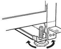
5. Pousser vers le haut sur la partie supérieure arrière de la machine à glaçons pour repérer les pieds de nivellement qui se trouvent sur le fond arrière de la machine à glaçons.
