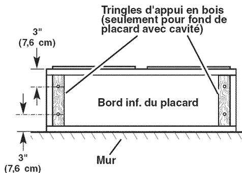
1. Sur le mur et le placard dans la zone où le passage du conduit d'évacuation va être réalisé, déterminer et tracer l'axe central vertical.
