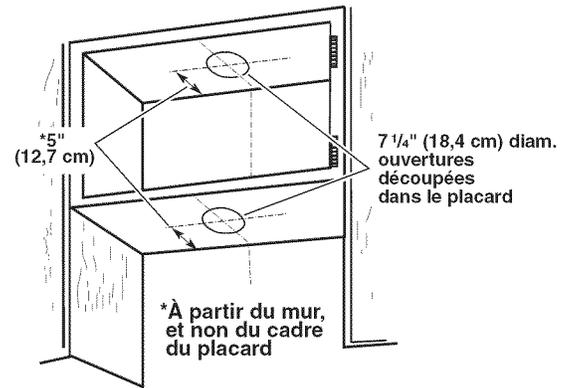
**Style 3 - Découpage d'ouverture pour un conduit rectangulaire de 3¼" x 10" (8,3 x 25,4 cm) sur raccord de transition rond de diamètre 7" (17,8 cm)**
