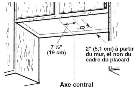
3. Câblage à travers le mur arrière :
