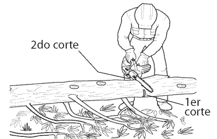
Figura 18 - Trozado del tronco apoyado sobre un solo extremo
