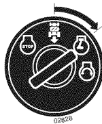
Motor en posición "ON" (Operación Normal)
